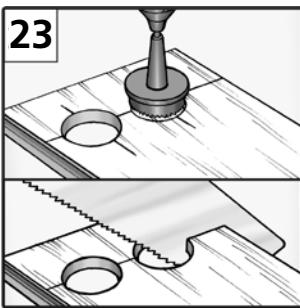
Kod cevi za grejanje se moraju izbušiti rupe koje su 3 cm veće od prečnika cevi, deo koji se kasnije uglavljuje se iseče, premaže lepkom, uglavi i fiksira klinom dok se lepak ne osuši. Na kraju se pokrije naglavkom [22, 23, 24].
